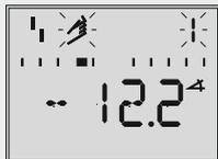
Ein **nicht initialisierter Stellungsregler** zeigt nach der Laufschrift *tES-tinG* das  $\blacksquare$ -Störmeldesymbol und blinkend das  $\text{☞}$ -Handsymbol an. Der Zahlenwert gibt die Hebellage in Winkelgrad relativ zur Mittellachse wieder.
