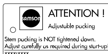
Fig. 3: Targhetta in caso di pacco premistoppa regolabile
